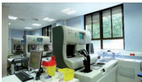
Figura 7: Mesas conectadas a la cadena mediante las cuales se cargan los tubos a los analizadores Coulter
