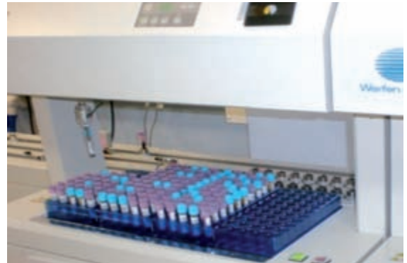
Figura 3: Módulo de entrada donde se cargan los tubos en los transportadores individuales
